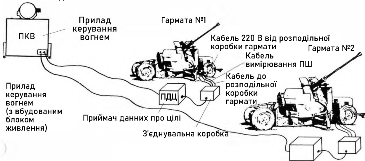
Рис. 13. З'єднання для дистанційного керування. Зовнішні кабелі не входять до комплекту постачання гармати.
