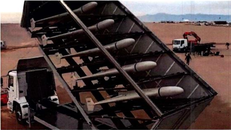
Рисунок 1.3 – Пускова установка БпЛА “Shahed 136”, замаскована під самоскид
