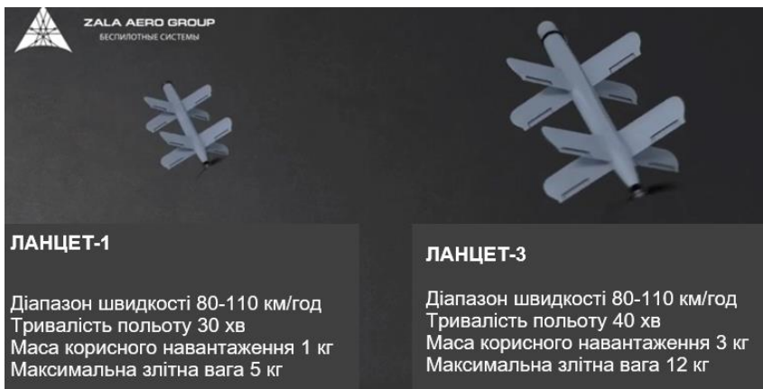
Рисунок 1.4 – Характеристики ударних БпЛА “Ланцет - 1” і “Ланцет - 3”
