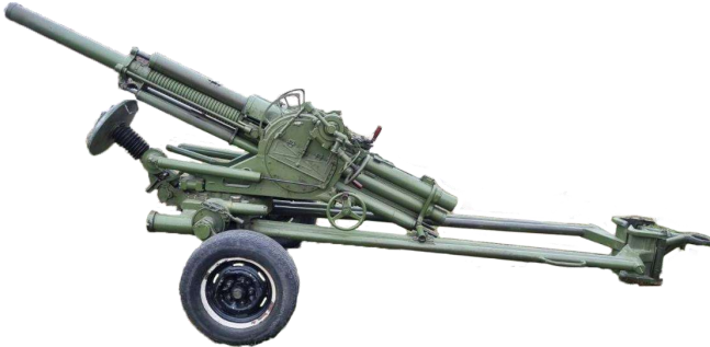
Рисунок 8 – 82-мм міномет 2Б9
