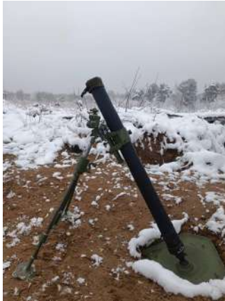
Рисунок 7 – 82-мм міномет М69А
