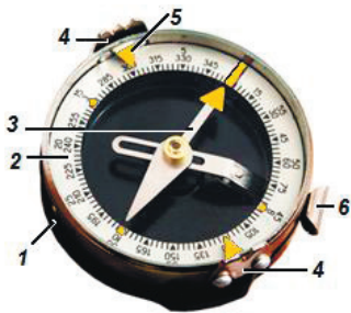
Рис. 1.2. Компас Адріанова: 1 - корпус; 2 - шкала (лімба); 3 - магнітна стрілка; 4 - візорний пристрій (мушка і цілик); 5 – показчик відліків; 6 - гальмо
