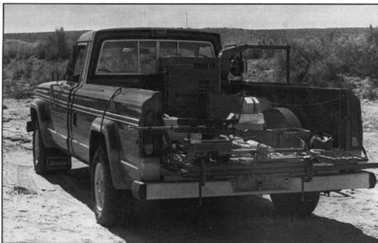
Малюнок 2-1 – Фотографія польової тестової установки показує гвинтівку, встановлену на верстат, та вимірювальне обладнання.
