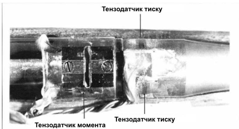
Малюнок 2-3- Фотографія переднього кільця ресивера та стовбура демонструє два тензодатчики змонтованих над патронником стовбура для вимірювання тиску та один із чотирьох датчиків на передньому кільці ресивера для вимірювання
