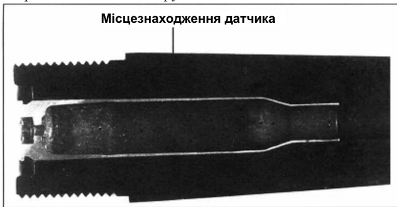
Малюнок 2-7- Розріз патронника та гільзи калібру 270 Вінчестер
