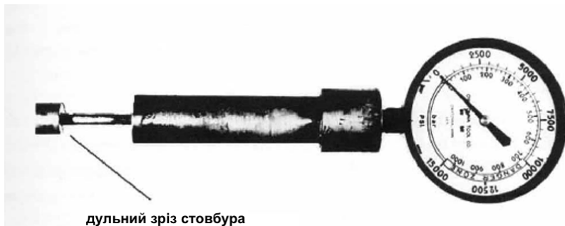
Малюнок 2-10 – Фотографія Гідравлічного циліндра та манометра, використаних у процесі калібрування тиску в патроннику.
