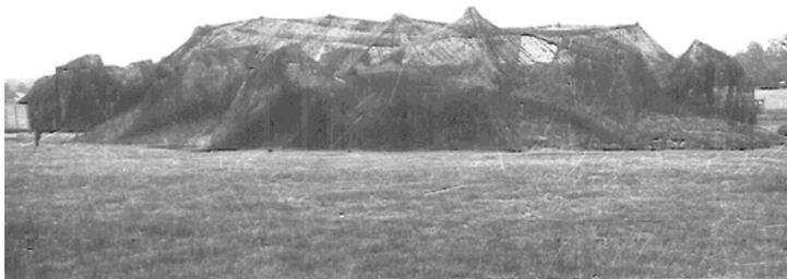
Рис. 1.3. Маскировка самолета комплектом маски «Зонт-1»
