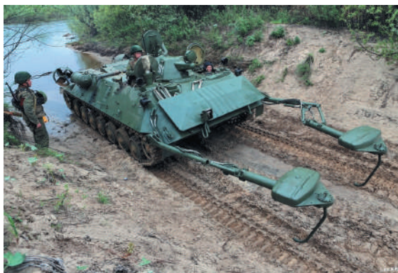
Рис. 1.3. ИРМ проводит инженерную разведку водной преграды [3]
