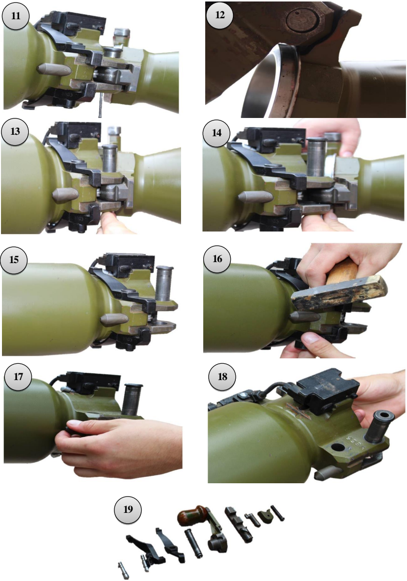
Рисунок 8 – порядок розборки викидного механізму.
