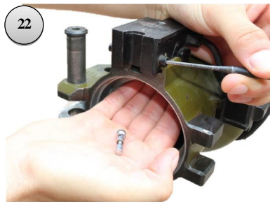
Рисунок 9 – порядок розборки корпусу контактної пристрою.
