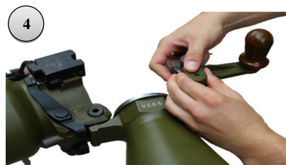
Рисунок 7 – порядок розбору замикаючого механізму і відокремлення затвора від ствола.
