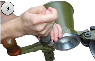
Рисунок 7 – порядок розбору замикаючого механізму і відокремлення затвора від ствола.
