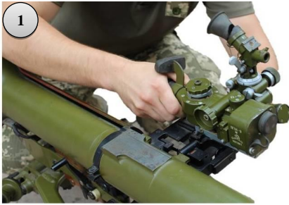
Рисунок 6 – порядок відокремлення від гранатомета оптичного прицілу.
