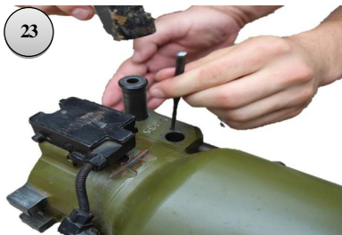
Рисунок 10 – порядок розборки фіксатора затвора.
