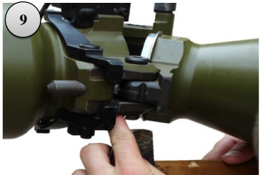
Рисунок 7 продовження – порядок розбору замикаючого механізму і відокремлення затвору від ствола.
