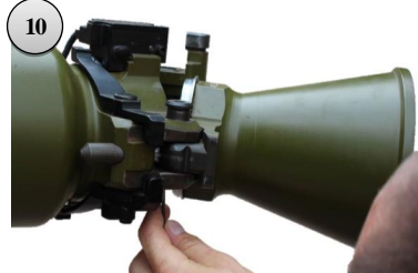
Рисунок 7 продовження – порядок розбору замикаючого механізму і відокремлення затвору від ствола.
