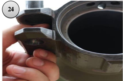
Рисунок 10 – порядок розборки фіксатора затвора.
