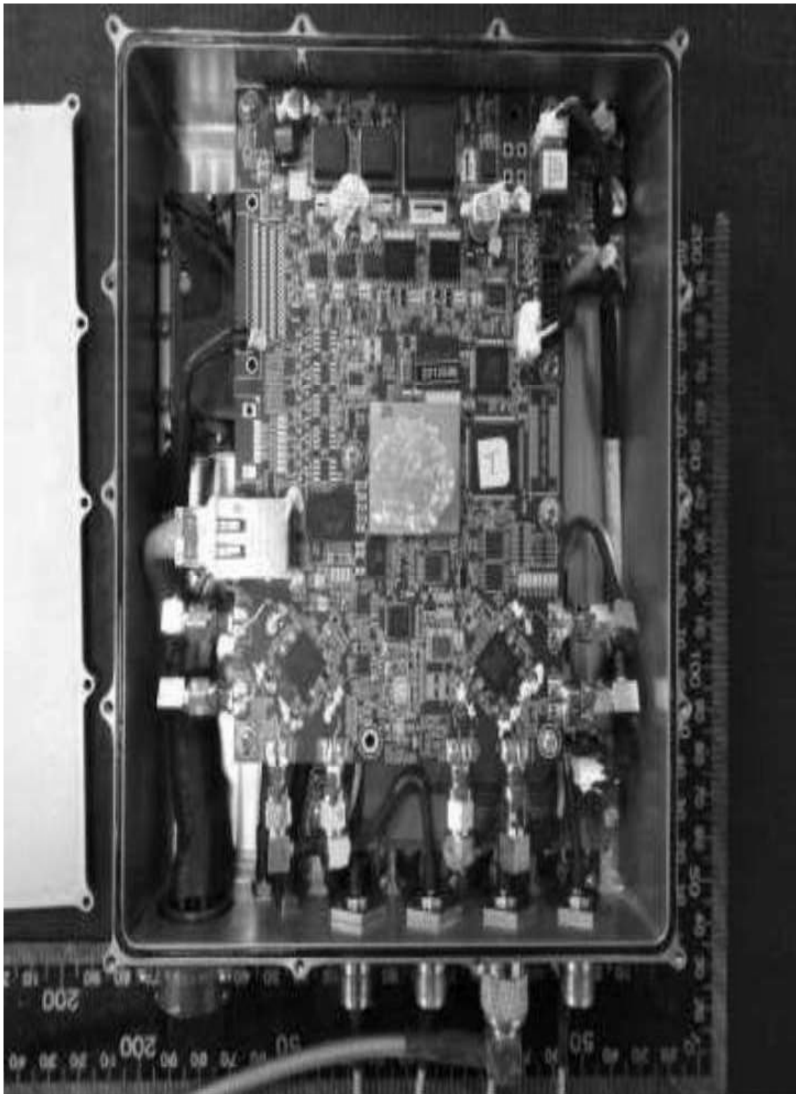
Рис. 21 Содержимое Трансивера (GNSS Transceiver)
