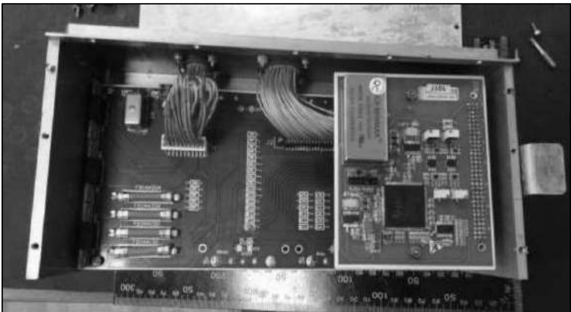
Рис. 16 Содержимое Блока распределения питания
