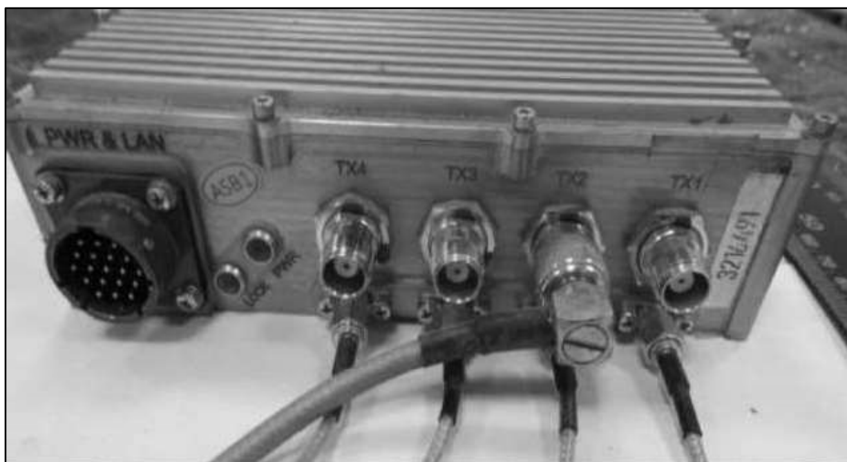
Рис. 20 Трансивер системы навигации (IRN-05 GNSS Transceiver)
