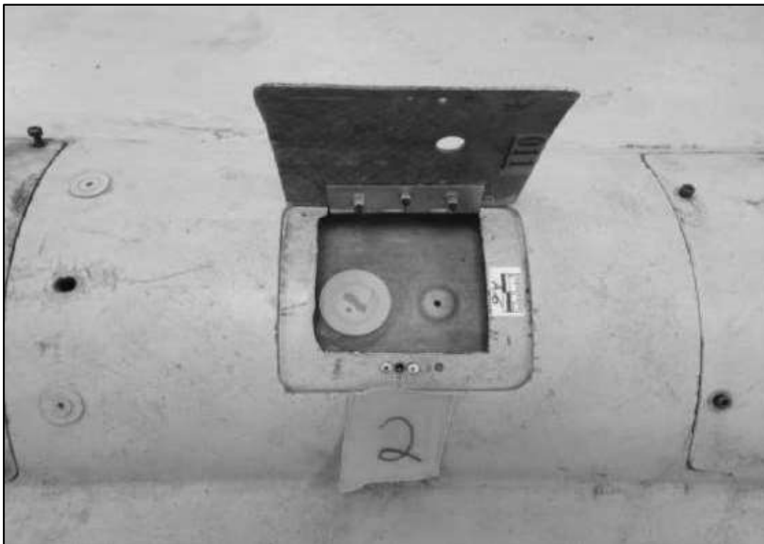
Рис. 9 Панель № 2 - Топливный бак БПЛА "Shahed-131" (Герань-1)
