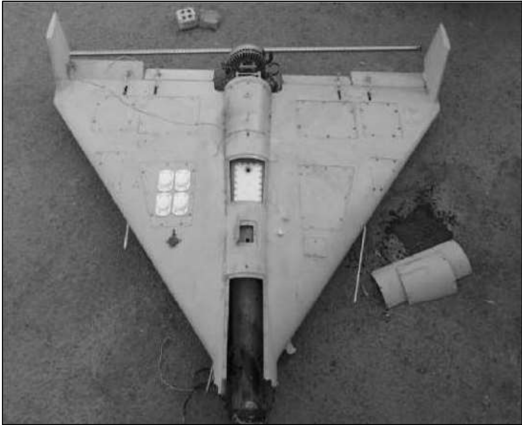
Рис. 3 БпЛА "Shahed-131" (Герань-1) вид снизу
