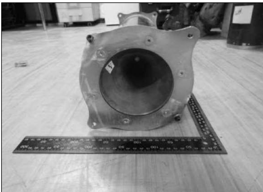
Рис. 6 боеголовка с медным корпусом для формирующего заряда
