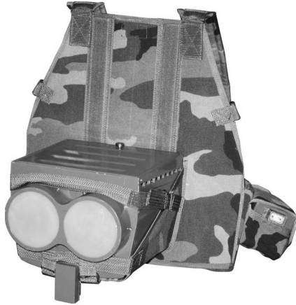
Рис. 9. патрульний радіолокатор 12L1 “Борсук” (Україна)
