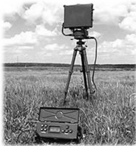
Рис. 6. Станція ближньої розвідки СБР-5М1 “Фара-1” (рф)
