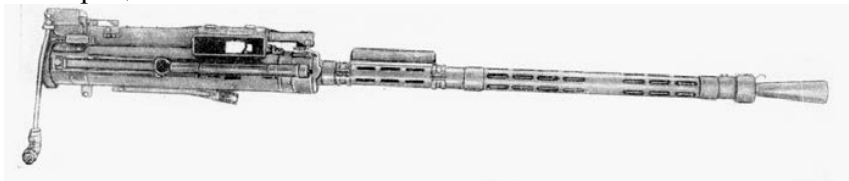
Мал. 1. Загальний вигляд 14,5-мм крупнокаліберного кулемета Володимирова (КПВТ)
