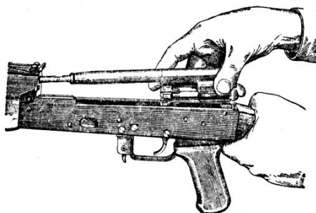
Мал. 9. Від'єднання затворної рами із затвором
