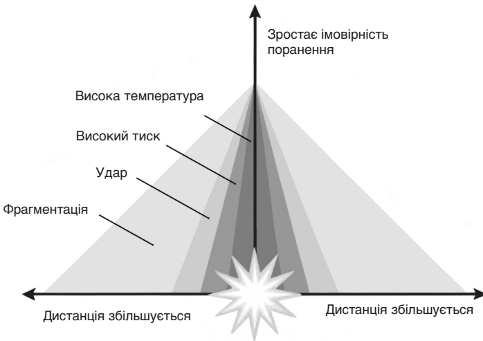
Рис. 1-3. Імовірність отримати певний вид травми пов'язана з дистанцією від епіцентру детонації.
