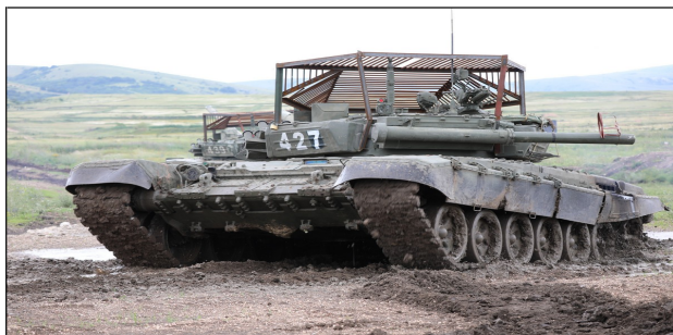
Рис. 7. Танк с защитным стальным козырьком
