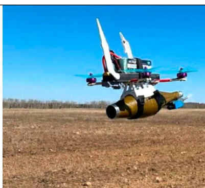
FPV-дрон камикадзе с боевой частью на базе выстрела от РПГ-7
