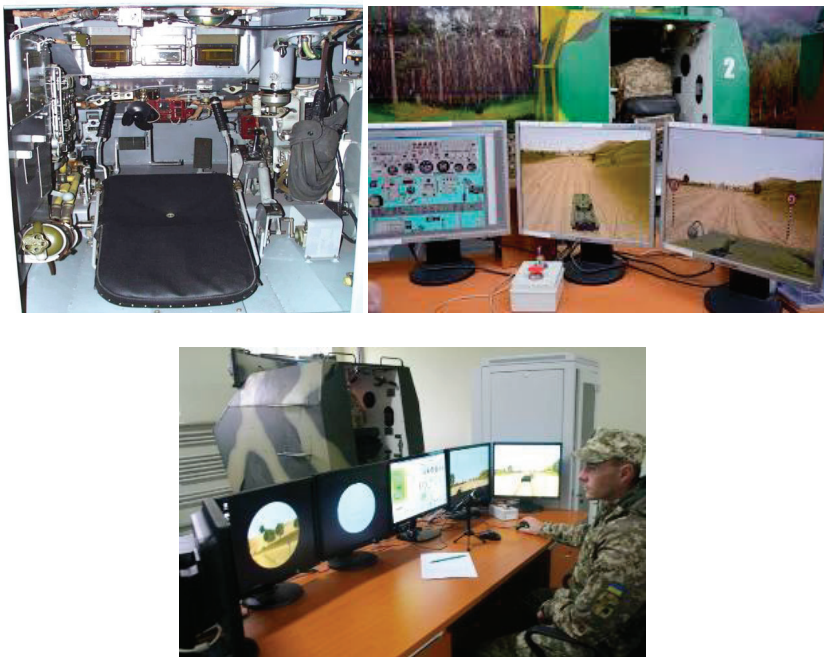
Рисунок 1 – імітатор відділення управління комплексного тренажера екіпажу танка Т-64Б та робоче місце інструктора.
