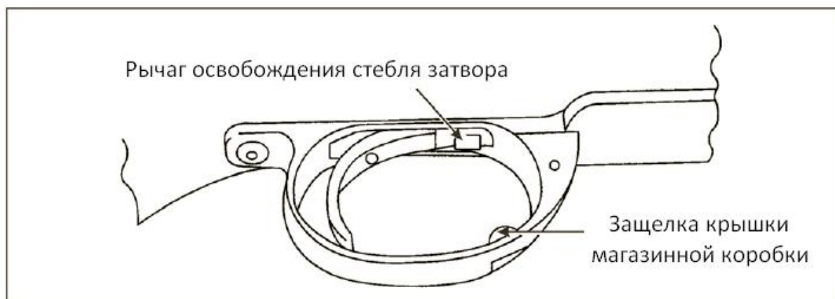
Рис. 2-3. Рычаг освобождения стебля затвора.
