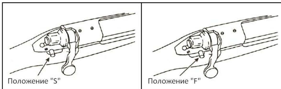
Рис. 2-2. Постановка и снятие винтовки M24 с предохранителя.
