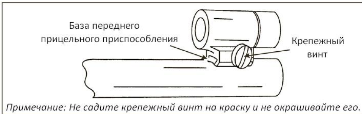
Рис. 2-7. Установка переднего прицельного приспособления.
