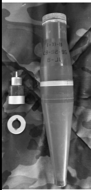
ПГ-9 (кумулятивная боевая часть).
