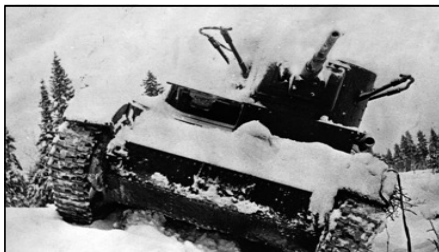
Радянський танк Т-26, підбитий в Карелії під час Зимової війни. Це командирський танк, на що вказує поручнева антена на башті
