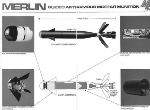
Рисунок 11 – 81-мм самонавідна кумулятивна міна “Merlin”.
