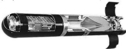
Рисунок 10 – 120-мм самонавідна кумулятивна міна “Strix”.
