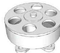
Бесколлекторный мотор типа «Pancake»
